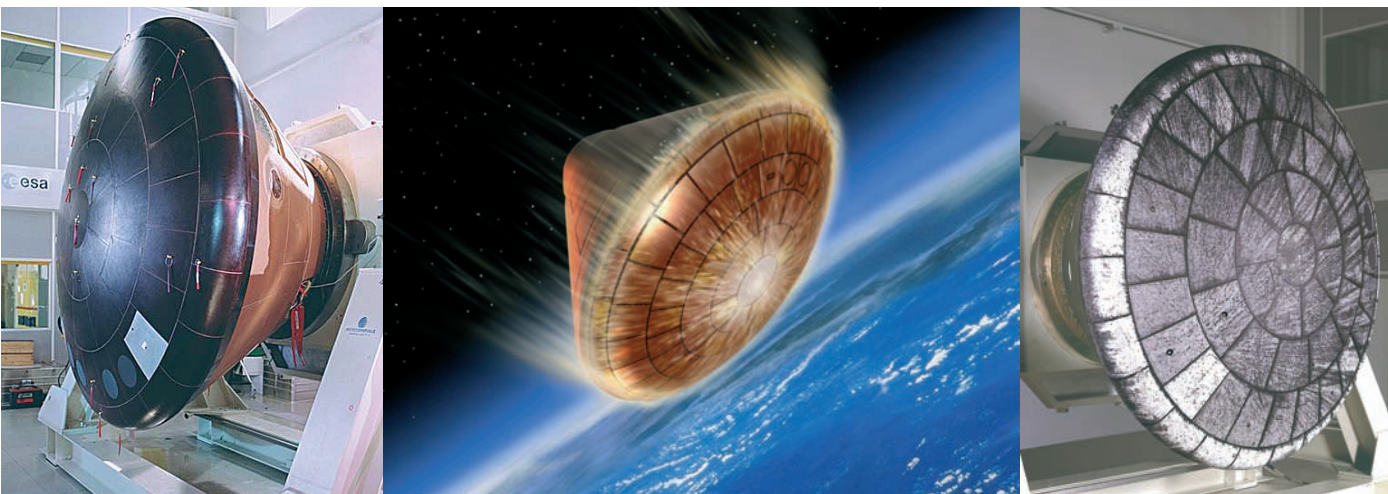
→ Escudo térmico de la cápsula ARD antes del lanzamiento, durante la reentrada (en interpretación artística) y tras la reentrada y recuperación. ESA
