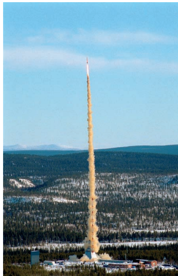
→ Lanzamiento del cohete balístico Maxus 4 desde el norte de Suecia en 2001. La carga útil se recuperará en paracaídas a 80 km de la base. ESA/ESRANGE/Lars Thulin
