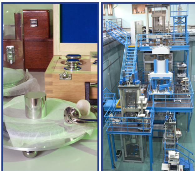
Patrones de dimensiones diversas: a la izquierda, Patrón Nacional del Kilogramo; a la derecha, máquinas patrón de fuerza de 1 kN, 20 kN, 500 kN y 10 MN.
